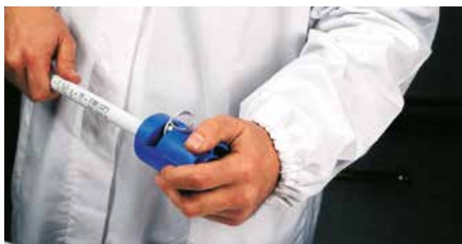
Fig 29 - Avskalning (steelPRES PP belagd)
