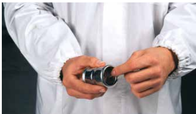
Fig 30 - Kontroll av tätningssring
